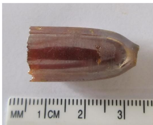
Рис. 1 Фотографія монокристалу Tl_3PbI_5 , який використовувався в оптично-спектральних дослідженнях
